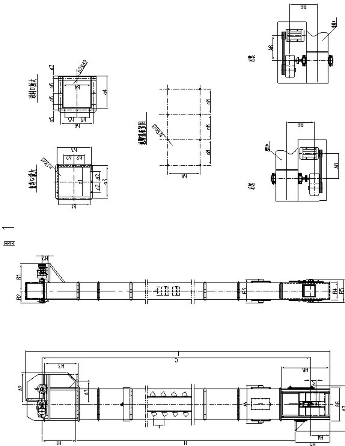
2. 中部机壳 (检修节): 机壳上装有大门, 用于安装、检修牵引部件, 每台一节 H=2 米。
